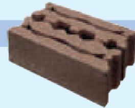
É um bloco de betão leve fabricado com agregados leves de argila expandida **Leca®**, concebido para aplicação em paredes de divisão entre fogos independentes ou de uma forma geral onde haja necessidade de controlar o nível de ruído aéreo.
